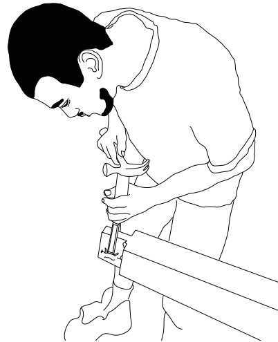
Travail avec un ciseau à bois pour décaper le tenon peu à peu
