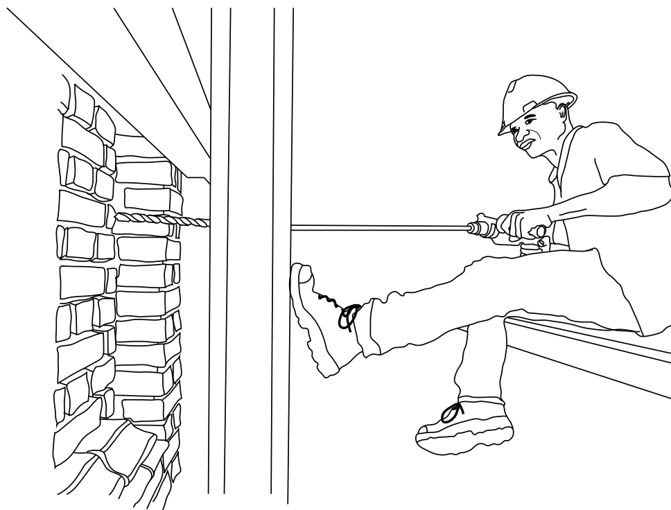
Perforation de la maçonnerie avec une mèche très longue
