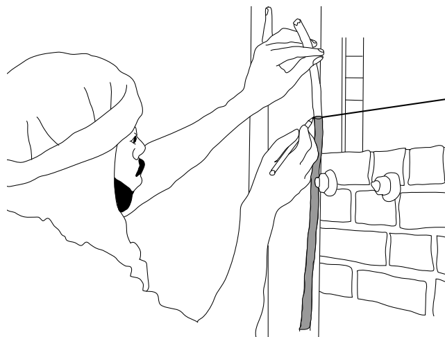
Tracer un trait puis fixer une ficelle qui sera le guide pour l'alignement vertical et horizontal
