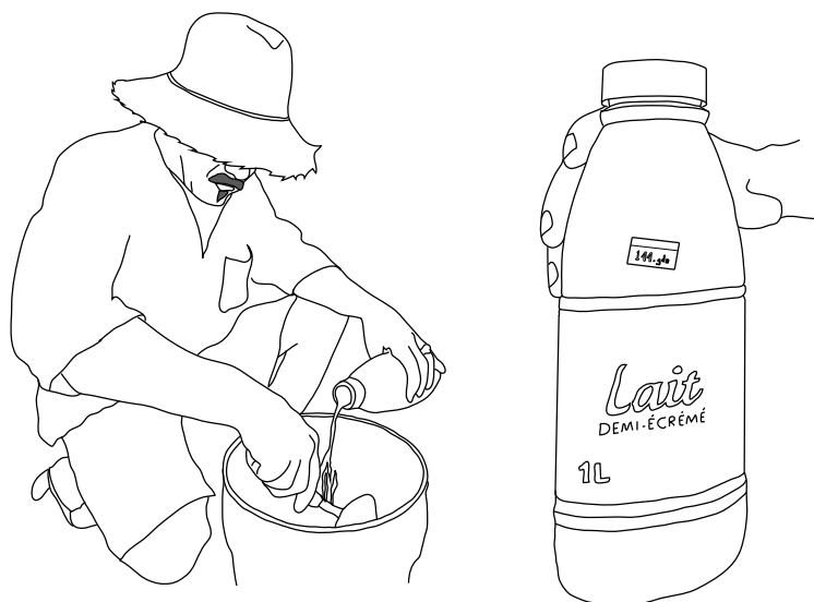
Préparation du badigeon avec du lait
