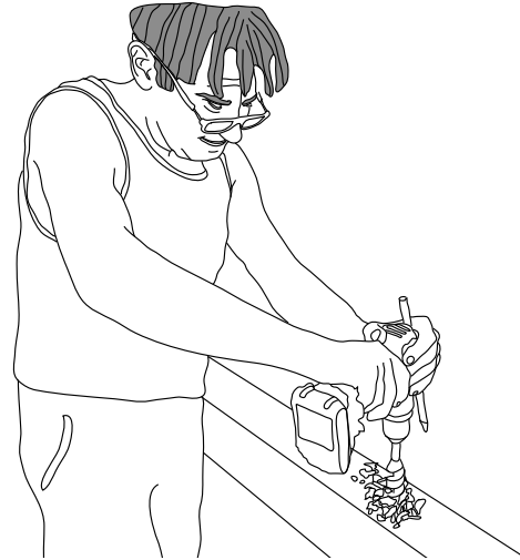
On peut commencer l'ouverture d'une mortaise avec une foreuse.
